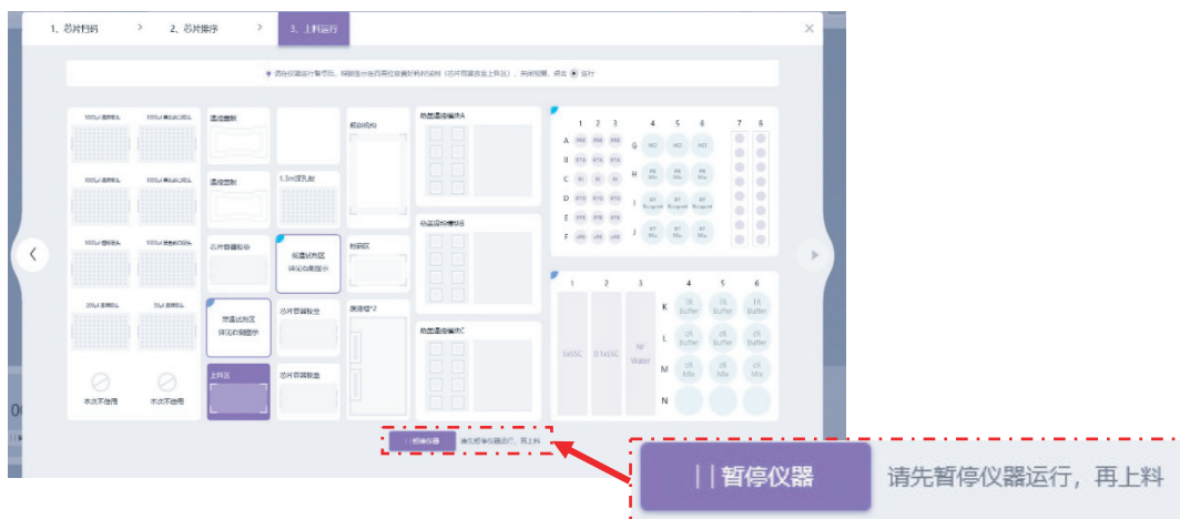
图 2-19 STOmics 软件流程暂停仪器多板上样界面
